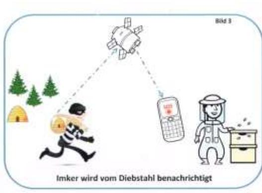
Sobald der Bienenstock bewegt wird, erhält der Imker per SMS die Benachrichtigung, dass sein Bienenstock unterwegs ist. Auf Grund der Nummer von der SIM-Karte kann er feststellen, um welchen Bienenstock es sich handelt.
